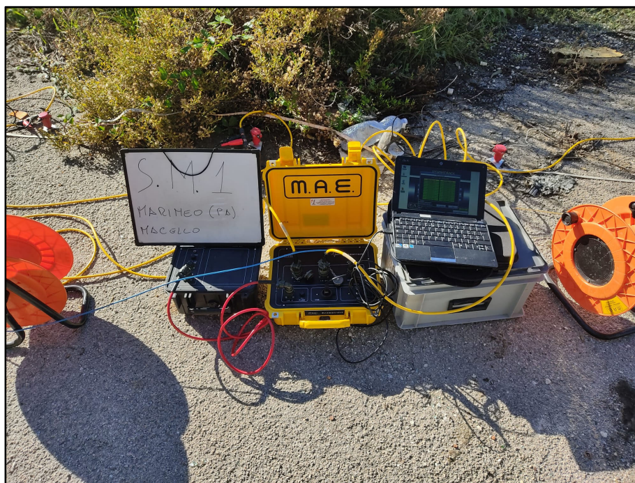
Sismografo MAE Sismatrack 24 geofoni 4.5 Hz
